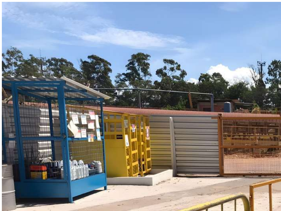
Figura 65 – Armazenamento de produtos químicos em gaiolas.
