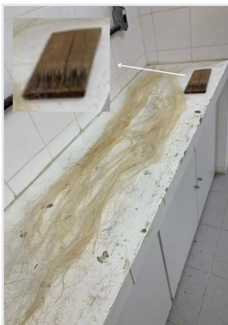
Figura 27 – Fibras de sisal escovadas com aparato de cerdas de pregos
