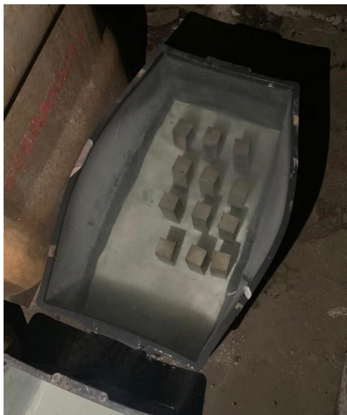
Figura 20 – Tanque de imersão
