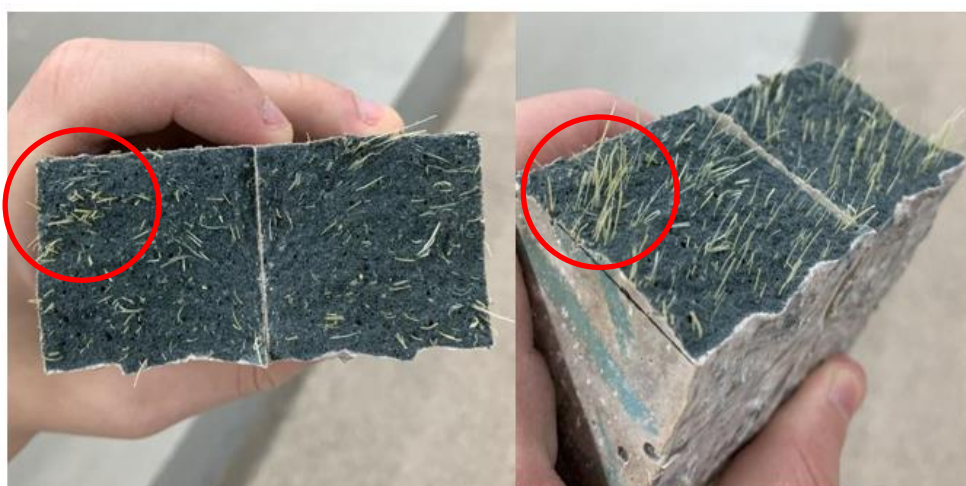
Figura 51 - Corpos de prova com 1,12 % de fibras de sisal
