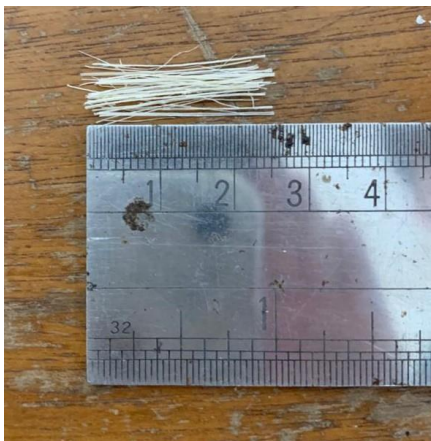
Figura 28 – Fibras de sisal cortadas em comprimento de 25 \pm 1 mm
