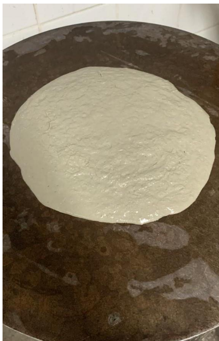
Figura 46 - Compósito reforçado apenas com fibras de sisal, com teor de 1,12 %
