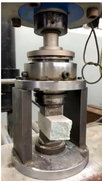
Figura 43 - Dispositivo de carga para ensaios de compressão
