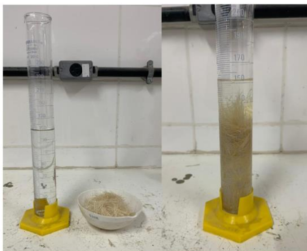
Figura 29 – Ensaio de massa específica do sisal utilizando proveta volumétrica graduada
