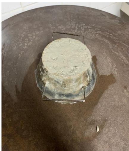
Figura 36 – Argamassa disposta no molde em formato de tronco de cone
