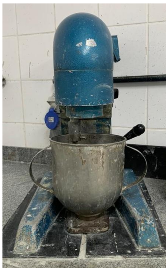
Figura 16 - Argamassadeira planetária com capacidade de 5 litros
