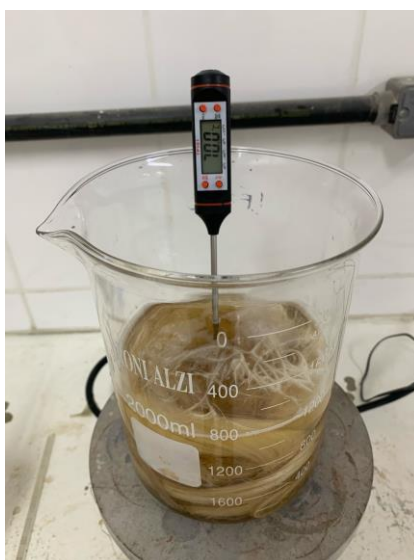
Figura 25 – Fibras de sisal em processo de beneficiamento submersas em água a 70 °C
