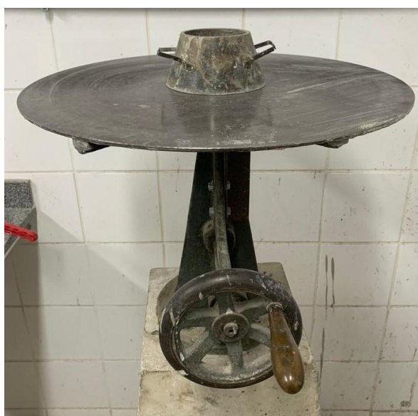
Figura 35 – Tronco de cone sobre a mesa de abatimento
