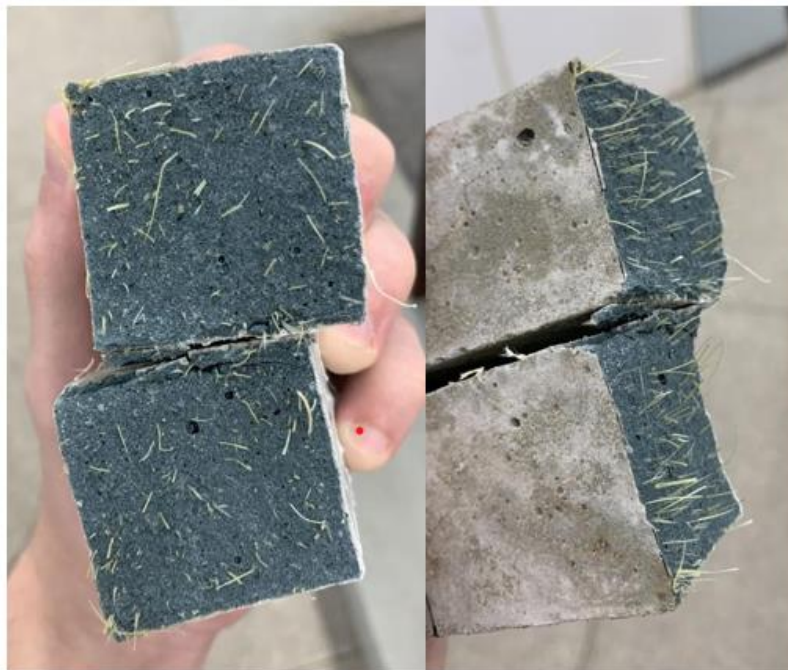
Figura 42 - Corpos de prova com 0,67 % de fibras de sisal
