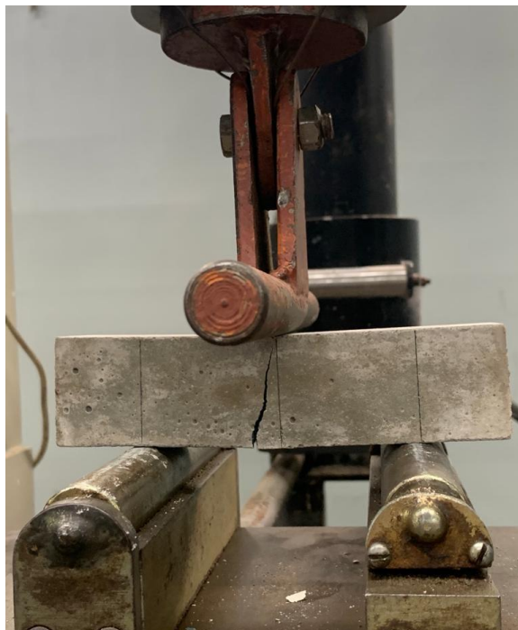
Figura 41 – Rompimento do corpo de prova
