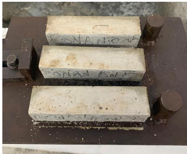
Figura 19 – Corpos de prova desmoldados
