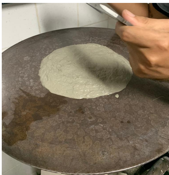
Figura 47 - Compósito reforçado com fibras de sisal e microcelulose, com teor de 1,5% de microcelulose
