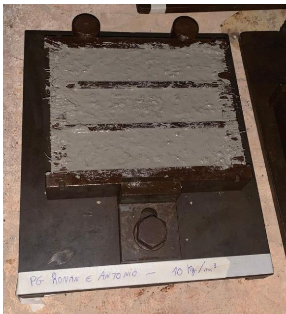
Figura 23 – Corpos de prova de 1,12 % de sisal moldados e levados para câmara úmida
