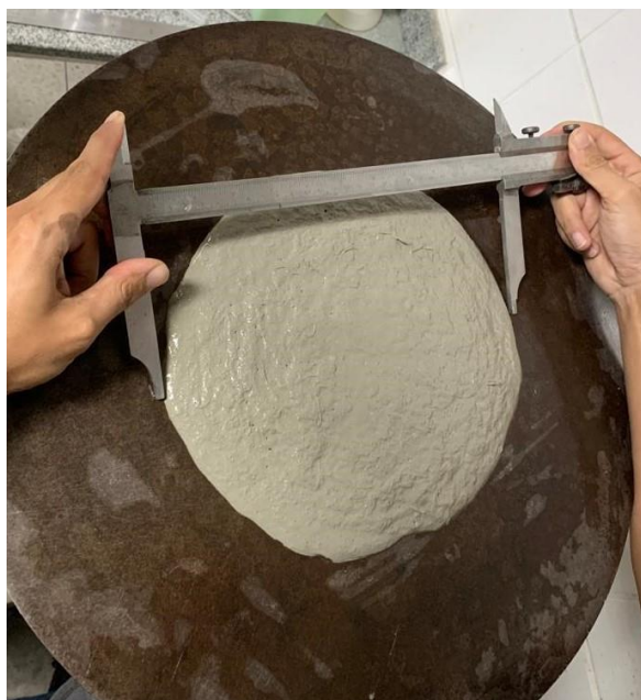
Figura 38 – Espalhamento da argamassa e medição dos diâmetros após os golpes
