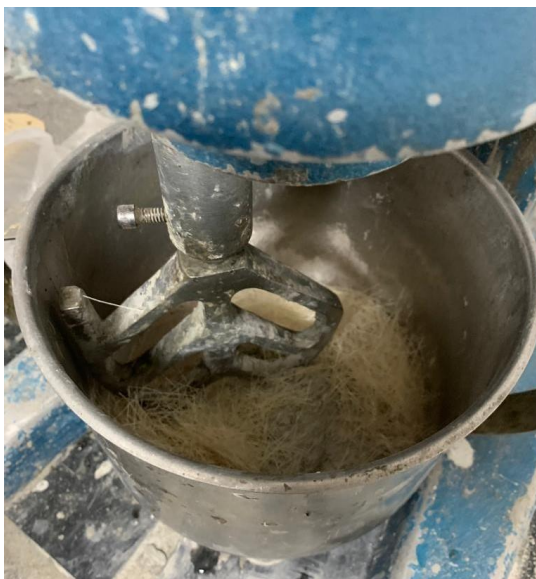
Figura 21 – Fibra de sisal adicionada na cuba juntamente com os materiais finos
