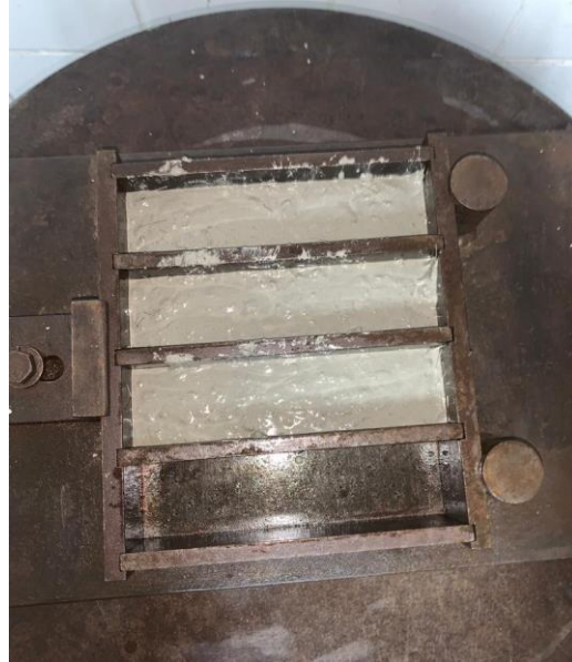
Figura 18 – Etapa de preenchimento dos moldes com a argamassa
