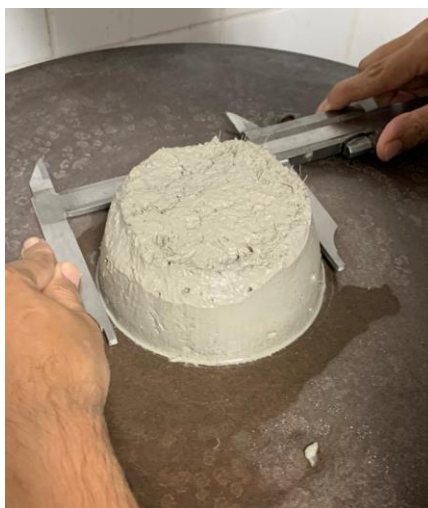
Figura 37 – Medição do diâmetro da argamassa antes dos golpes
