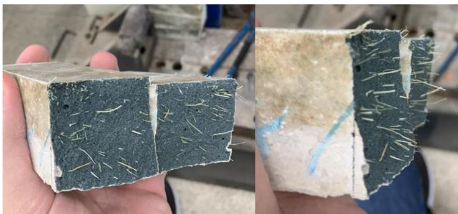
Figura 50 - Corpos de prova com 0,34 % de fibras de sisal
