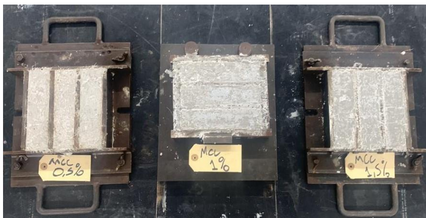
Figura 24 – Corpos de prova com fibra de sisal e microcelulose após 24 horas moldados
