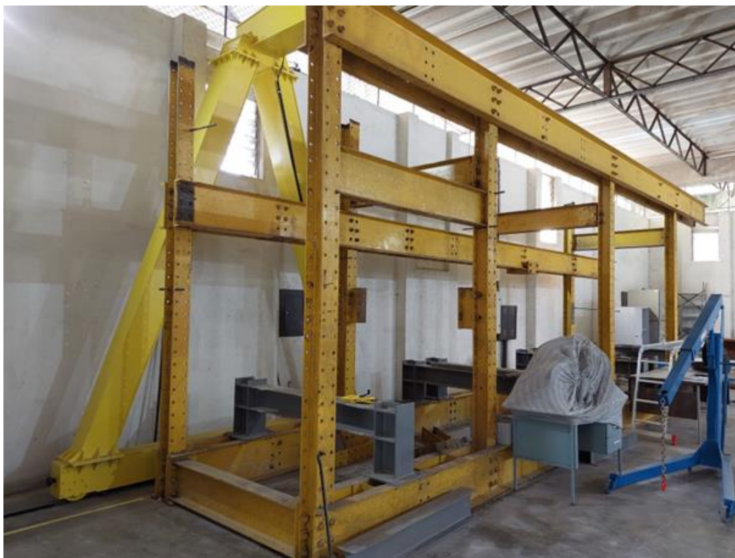
Figura 2 – Pórtico espacial de reação autoequilibrado do LEST-UFES
