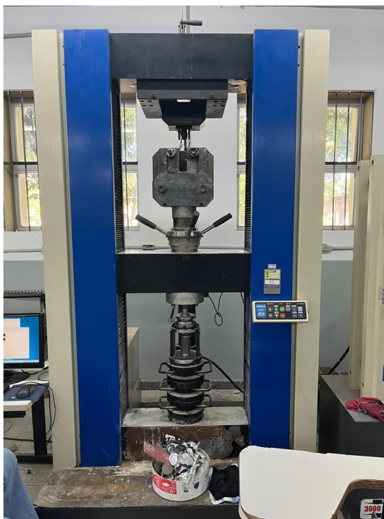
Figura 24 - Prensa hidráulica utilizada no ensaio de resistência à compressão
