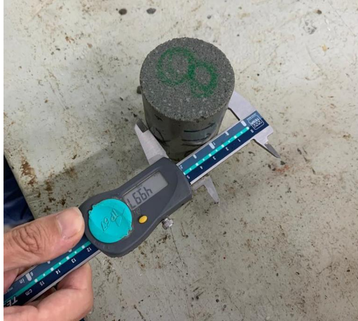
Figura 23 - Utilização do paquímetro digital para medição dos corpos de prova.
