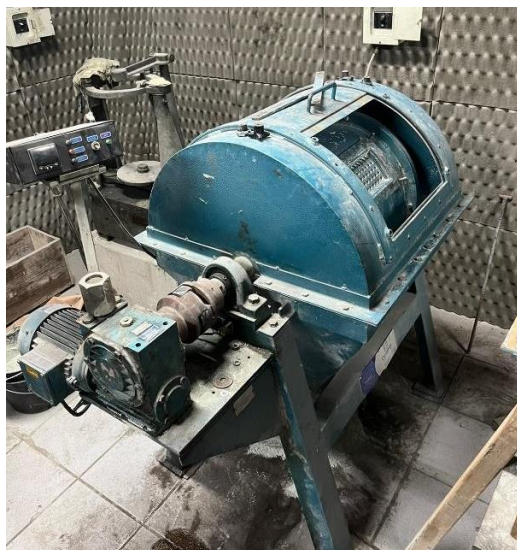
Figura 10 - Moinho de bolas utilizado na moagem da FNS.
