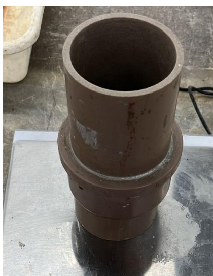
Figura 17 - Recipiente usado para cálculo da massa específica
