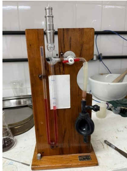
Figura 13 - Aparelho de permeabilidade Blaine utilizado no ensaio
