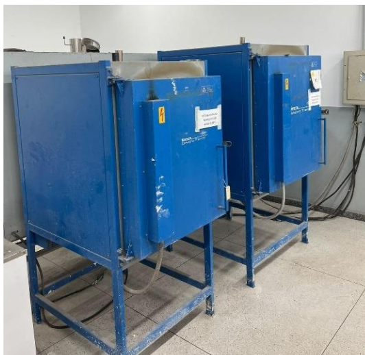
Figura 11 - Mufla utilizada para eliminação da matéria orgânica da areia
