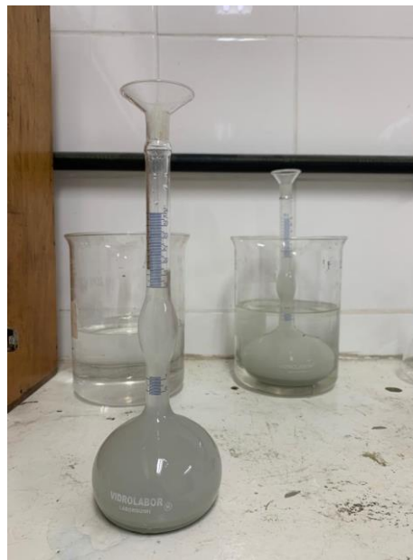
Figura 12 - Procedimento para obtenção da massa específica do FNS
