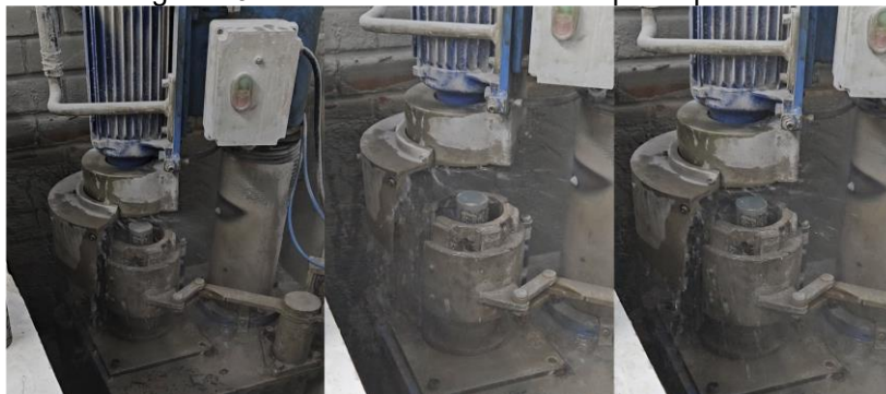
Figura 23. Processo de retífica do corpo de prova.
