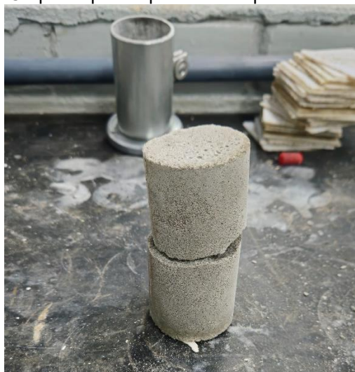
Figura 26. Corpo de prova quebrado no processo de desmolde.
