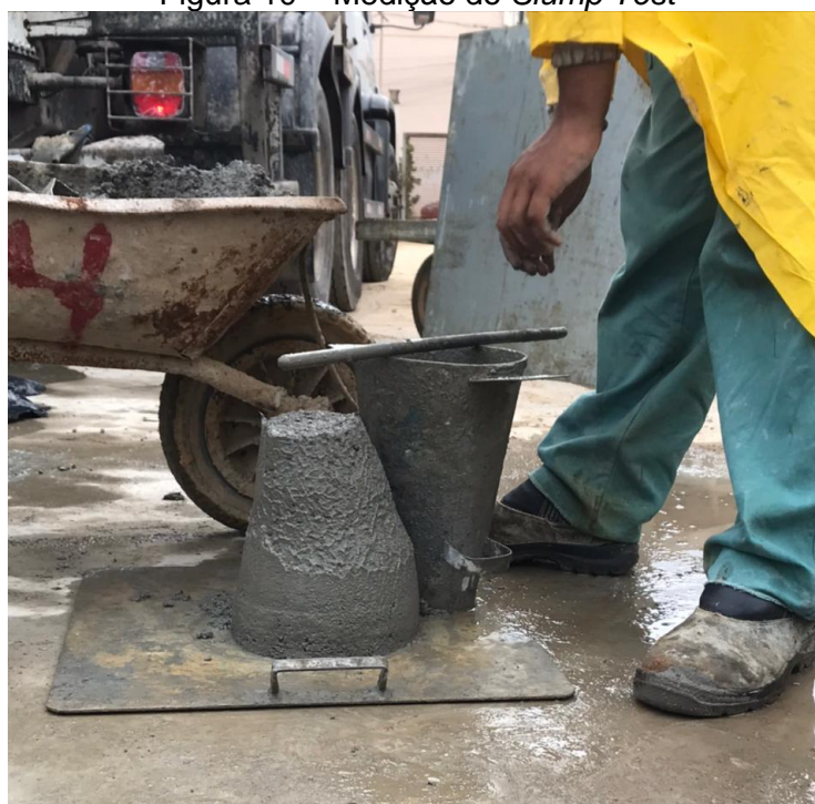
Figura 10 – Medição do Slump Test
