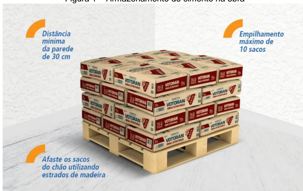
Figura 1 – Armazenamento do cimento na obra
