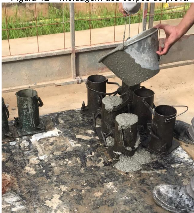
Figura 12 – Moldagem dos corpos de prova
