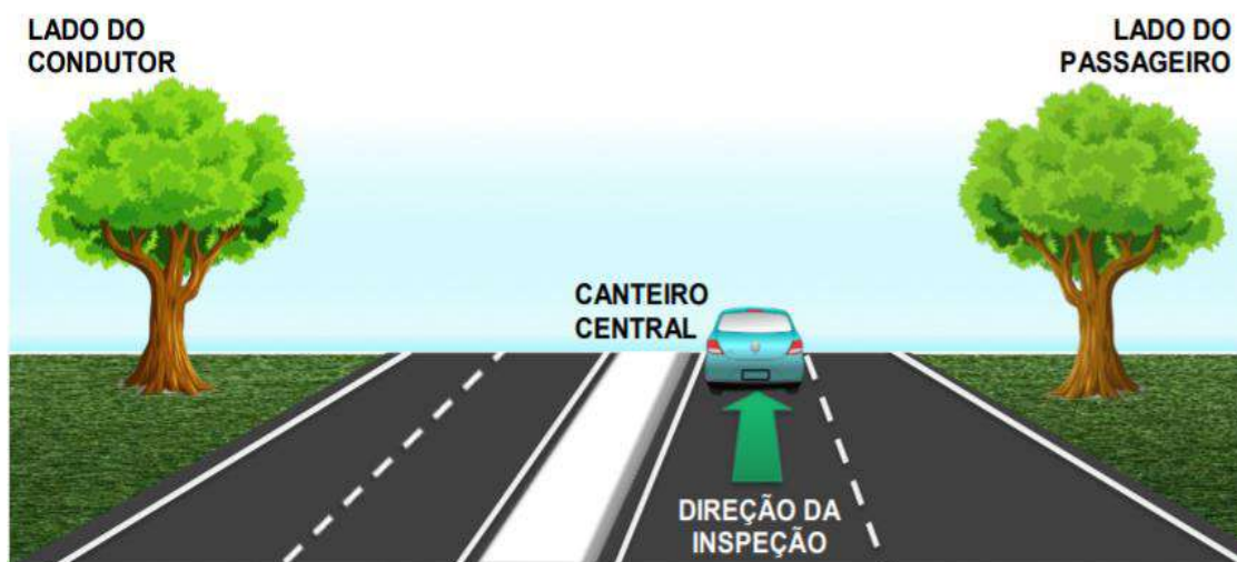
Figura 11 - Seção transversal indicando o lado do condutor e do passageiro em uma inspeção
