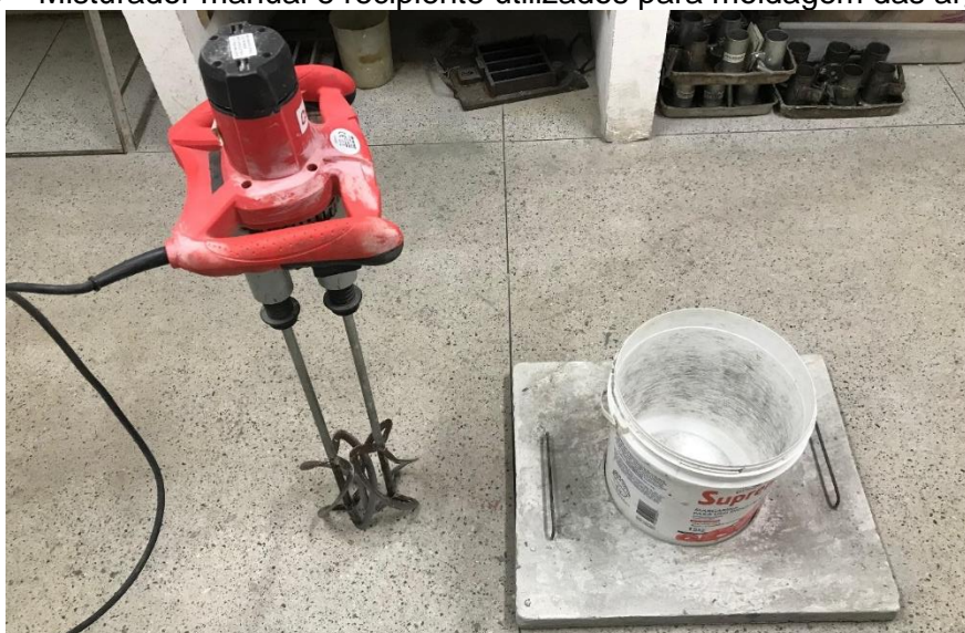
Figura 18 – Misturador manual e recipiente utilizados para moldagem das argamassas.
