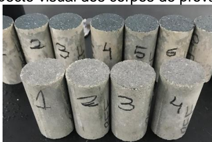
Figura 20 – Aspecto visual dos corpos de prova após a retífica.
