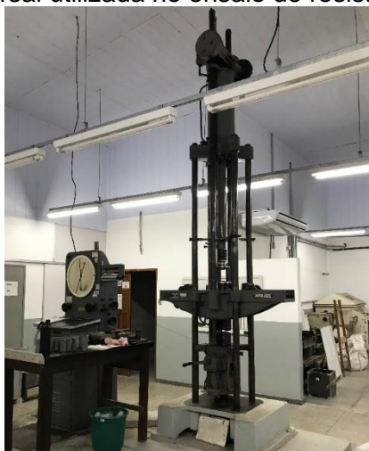
Figura 21 – Prensa universal utilizada no ensaio de resistência à compressão axial.
