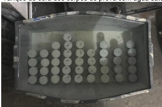
Figura 19 – Tanque de cura dos corpos de prova com água saturada de cal.
