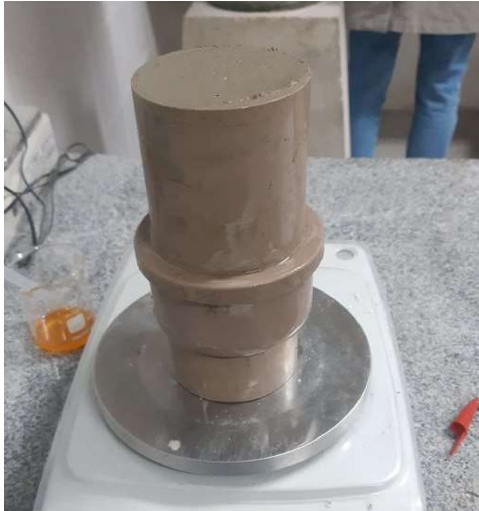
Figura 30 - Recipiente contendo graute para determinação da massa específica.
