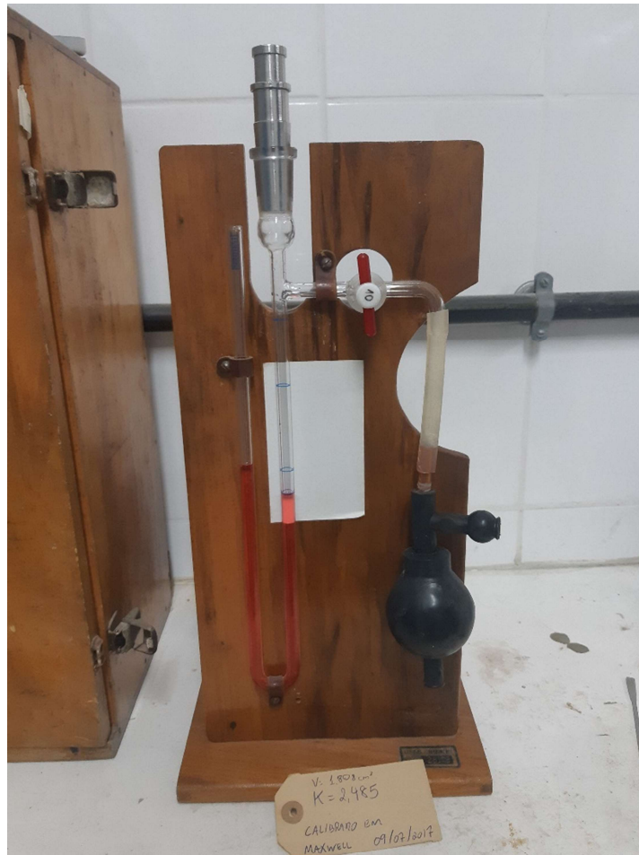
Figura 21 - Aparato utilizado no ensaio de finura Blaine
