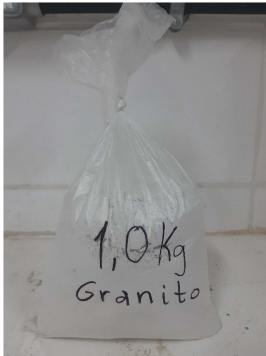
Figura 16 - Amostra de resíduo de beneficiamento de granito preparada para uso.
