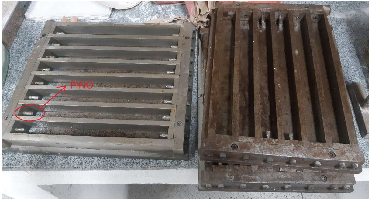
Figura 33 - Moldes prismáticos preparados para moldagem
