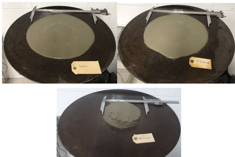
Figura 41 - Espalhamento dos grautes sem aditivo redutor de retração (REF, 5% RBRO e 10% RBRO)
