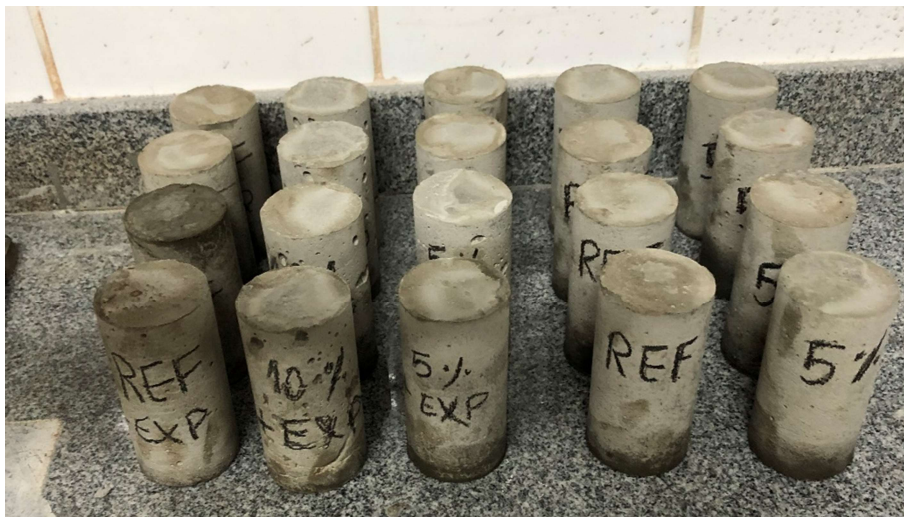
Figura 36 - Corpos de prova desmoldados e identificados
