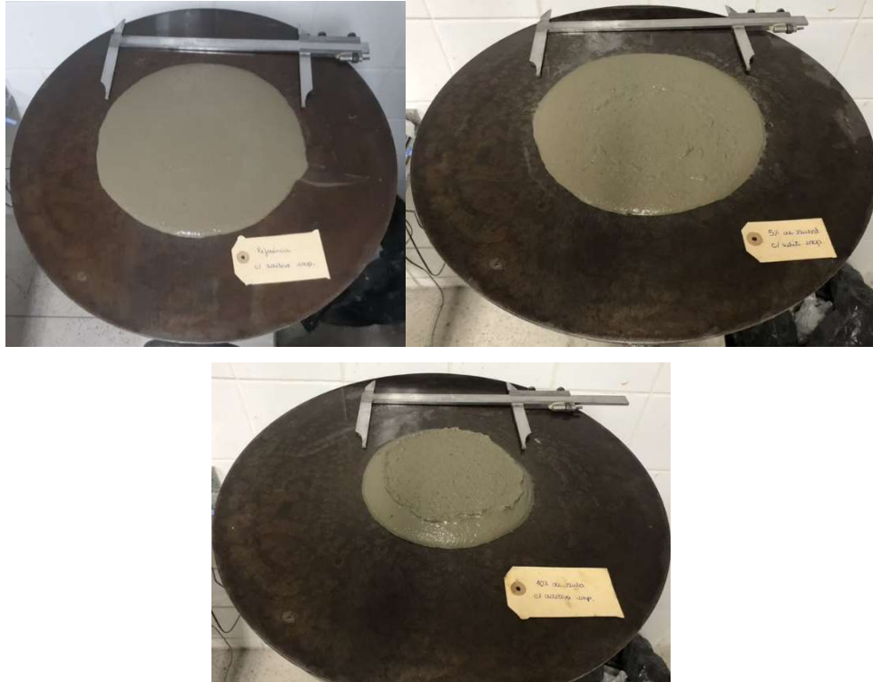
Figura 40 - Espalhamento dos grautes com aditivo redutor de retração (REF+RR, 5% RBRO+RR e 10% RBRO+RR)
