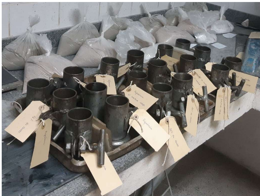
Figura 31 - Alguns dos corpos de provas cilíndricos usados no ensaio de resistência à compressão
