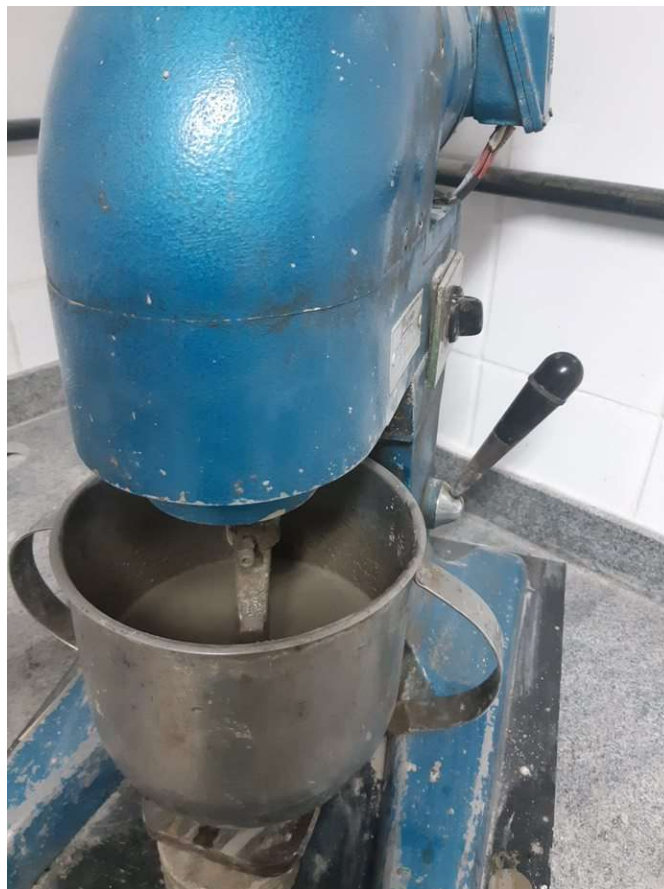
Figura 25 - Argamassadeira utilizada para a produção dos grautes.
