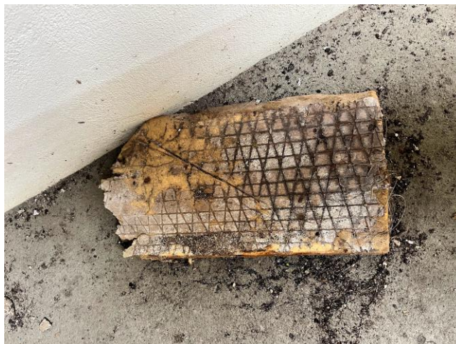
Figura 72– Fragmentos da telha na parte interior da edificação
