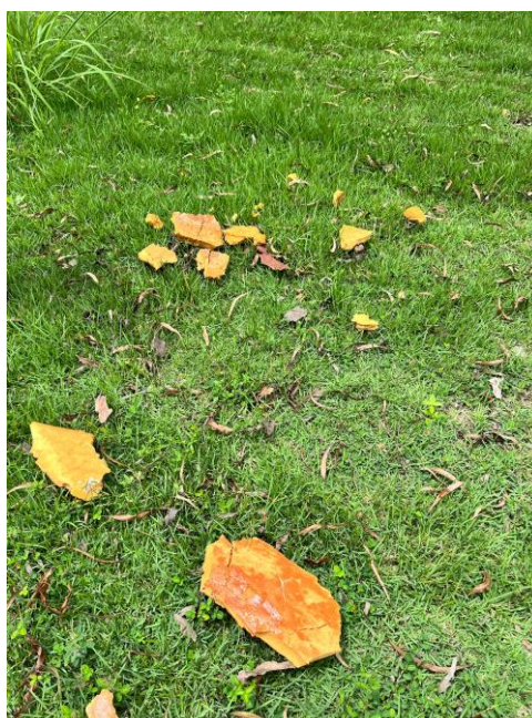
Figura 73– Fragmentos da telha na parte exterior da edificação
