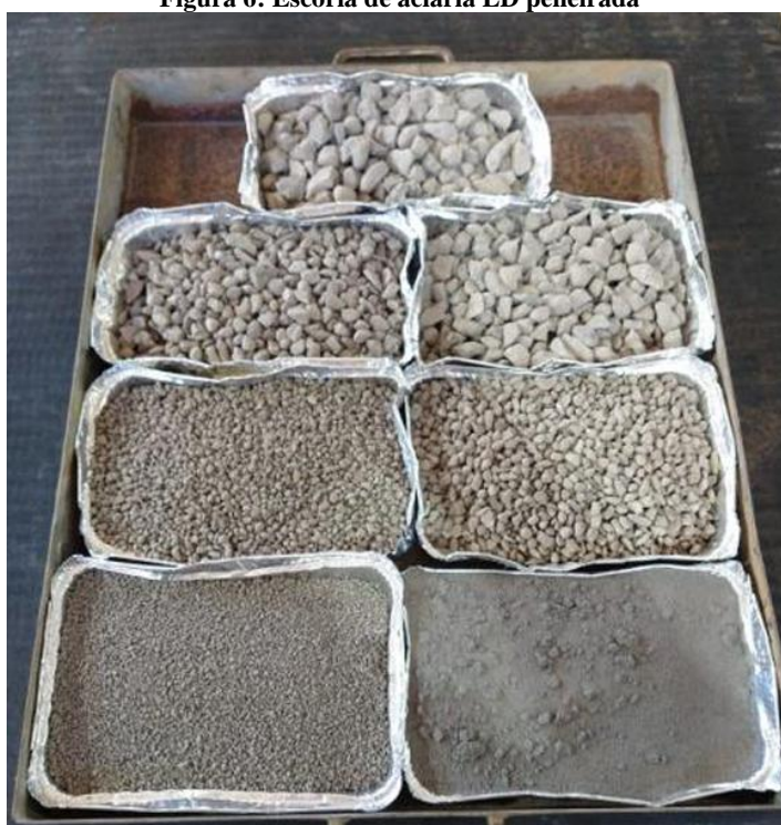
Figura 6: Escória de aciaria LD peneirada
