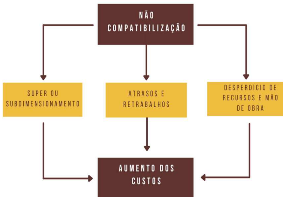
Figura 11: Consequência da falta de compatibilização de projetos.
