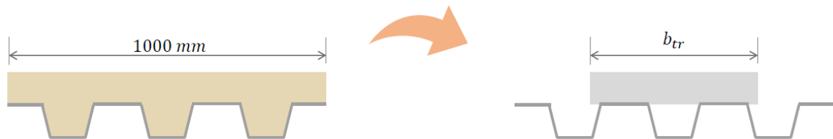
Figura 29: Homogeneização da seção transversal mista.
