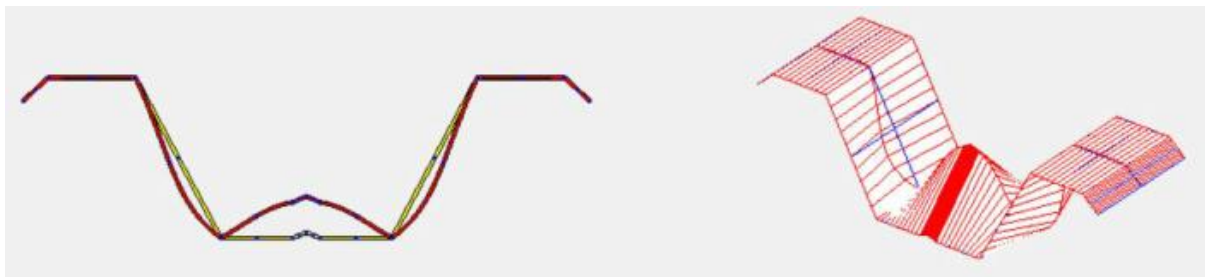
Figura 7 - Deformada correspondente à flambagem local - Momento fletor negativo.
