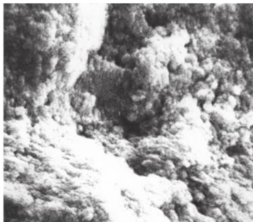
Figura 14 - Fotografia de MEV da microestrutura de um solo laterítico
