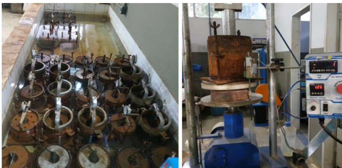
Figura 5 - Realização do ensaio CBR das 12 amostras
