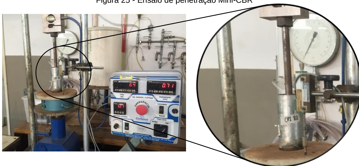
Figura 25 - Ensaio de penetração Mini-CBR
