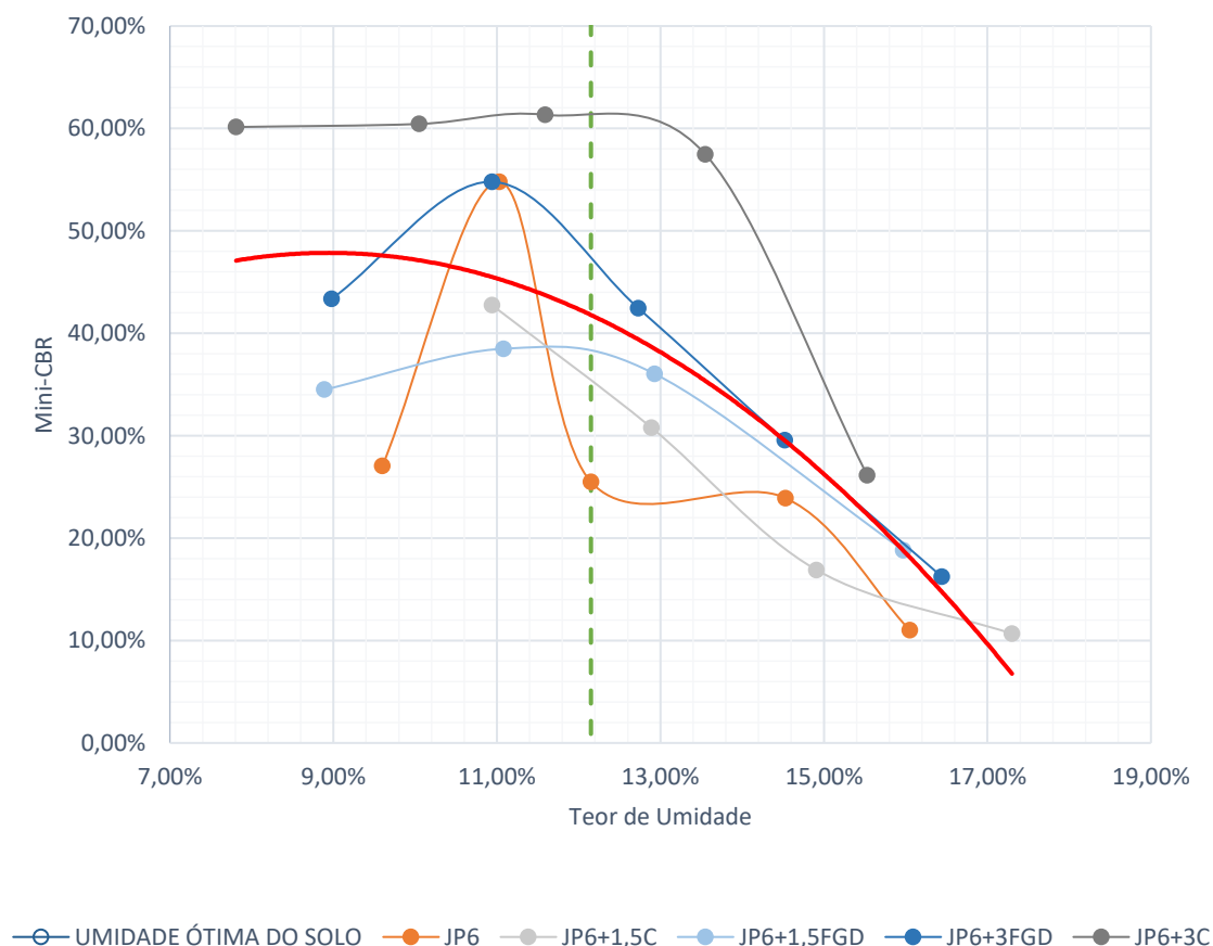
Figura 40 - Curvas do Mini-CBR de acordo a umidade das amostras
