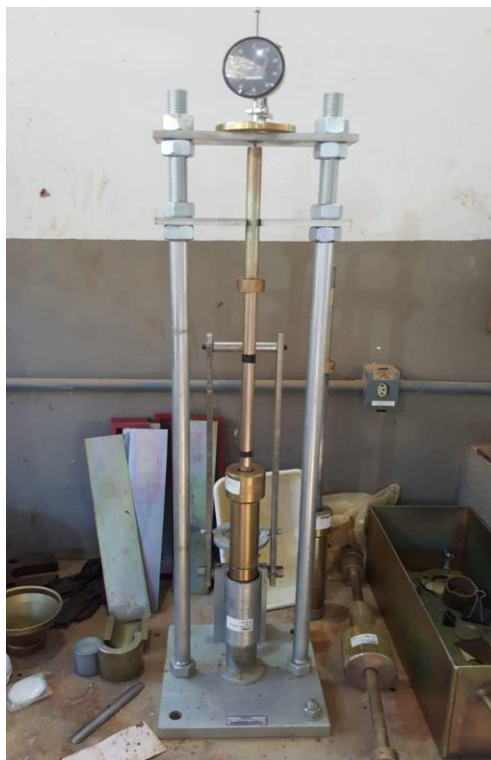
Figura 21 - Compactador do ensaio Mini-MCV
