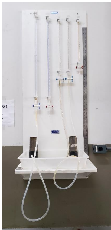
Figura 23 - Ensaio de permeabilidade com carga variável
