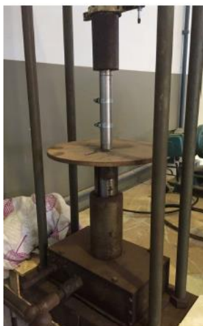
Figura 18 - Prensa manual utilizada para compactação de MAFs
