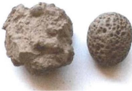
Figura 6 – Escória de aciaria solidificada ao ar e resfriada com água. Fonte: Geyer (2001).
