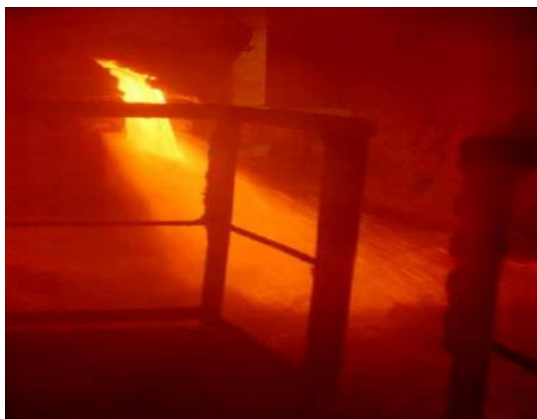
Figura 3 – Escória sendo resfriada com jatos de água. Fonte: Coelho apud Almeida (2014).
