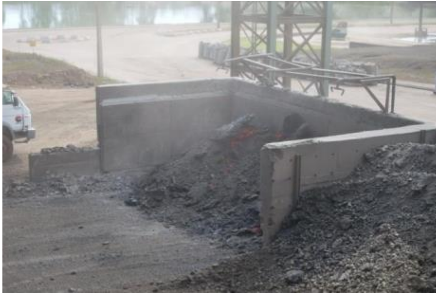
Figura 4 – Escória Dry-Pit resfriando em pátio. Fonte: Almeida (2014).
