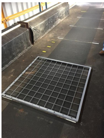
Figura 3.6 – Gabarito utilizado para marcação das trincas.
