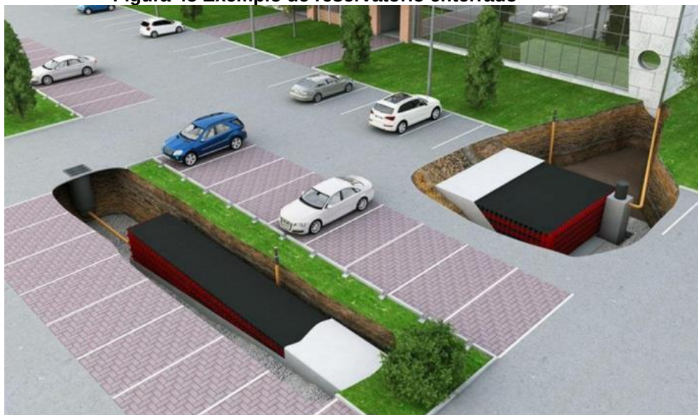
Figura 45 Exemplo de reservatório enterrado
