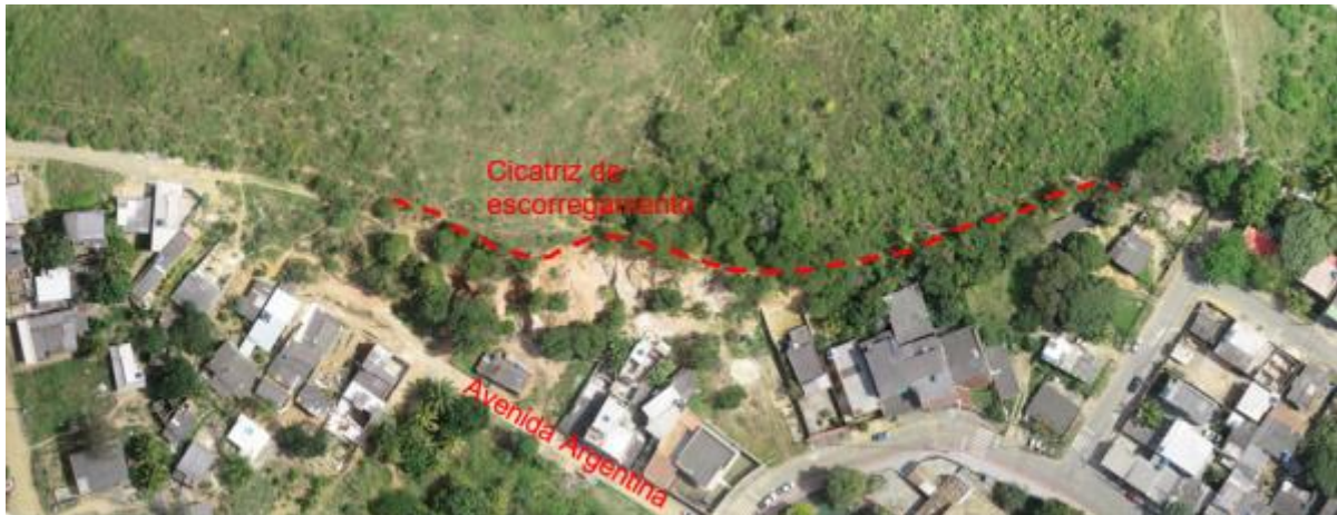
Figura 37 – Imagem de satélite da encosta com destaque na cicatriz de escorregamento
