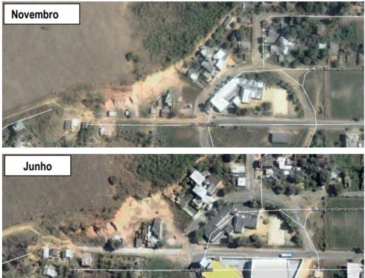
Figura 43 - Evolução do processo de escorregamento e erosão entre novembro de 2003 e junho de 2007
