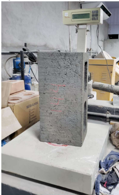
Figura 12 - Pesagem dos blocos em condição saturada superfície seca.
