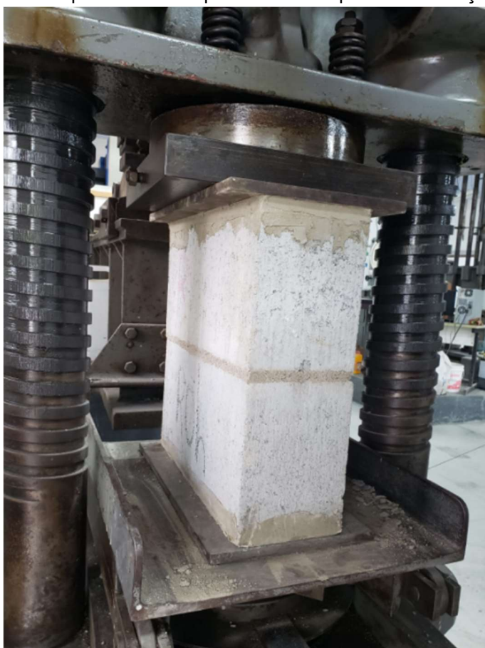
Figura 23 - Prisma posicionado na prensa com chapas de distribuição de forças.
