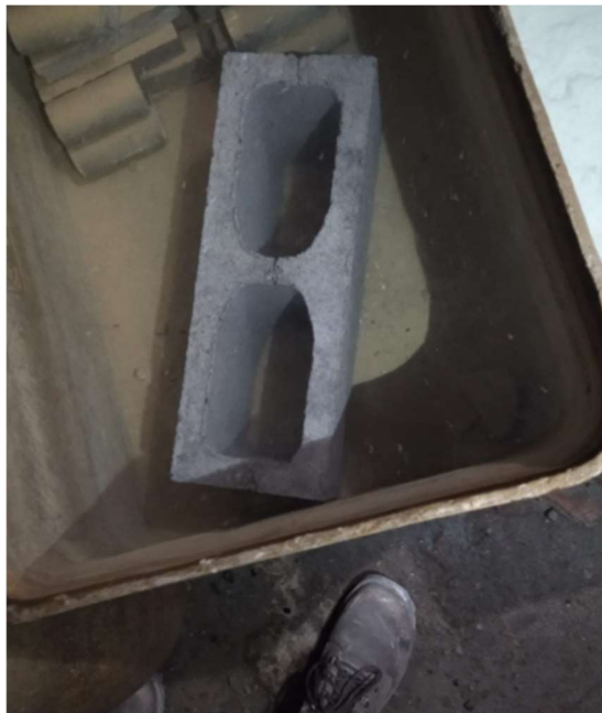
Figura 13 - Blocos submersos para ensaio de absorção.
