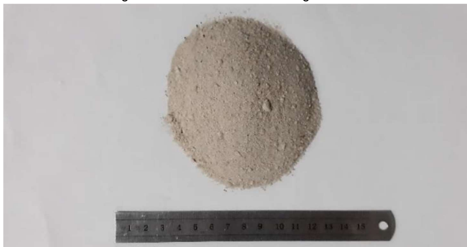
Figura 04 - Areia utilizada nas argamassas.
