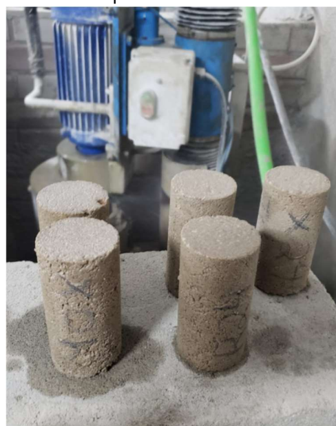
Figura 19 - (a) Posicionamento na máquina retífica para capeamento das extremidades dos corpos de prova. (b) Resultado do capeamento com máquina retífica.
