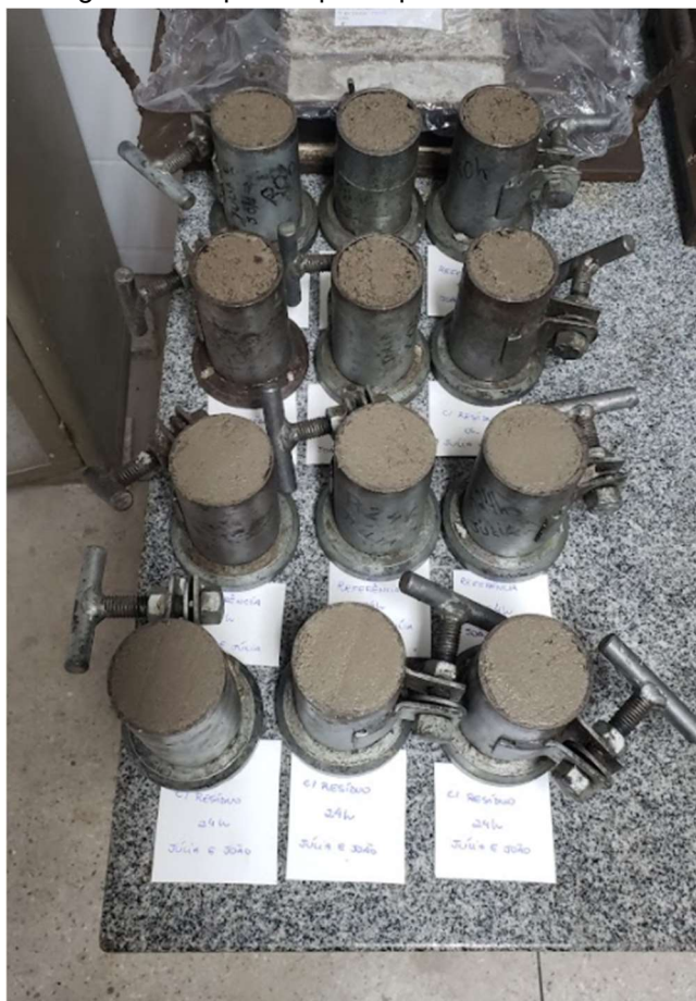
Figura 17 - Moldagem de corpos de prova para ensaios do estado endurecido.
