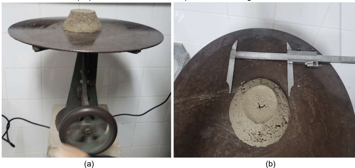
Figura 15 - (a) Argamassa posicionada na mesa durante a realização das quedas. (b) Aferição com paquímetro do diâmetro do espalhamento da argamassa.
