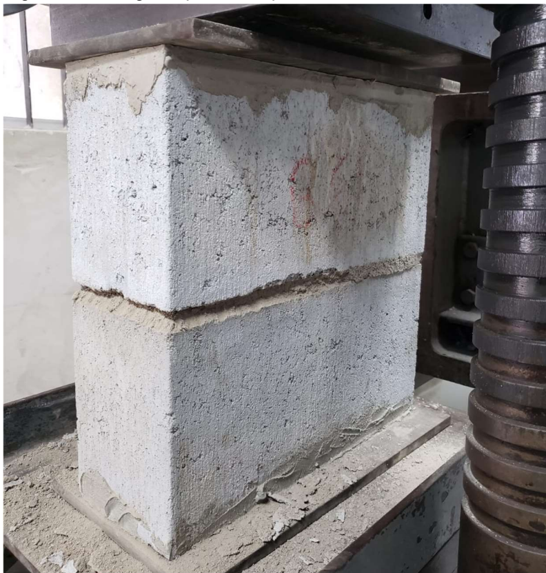
Figura 39 - Fadiga do prisma de par 138-121 sem fissura do bloco.
