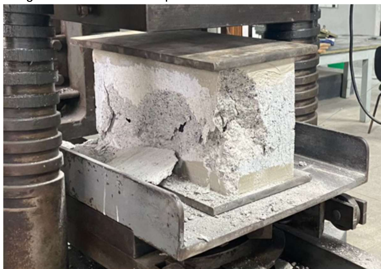
Figura 26 - Forma de rompimento dos blocos de concreto.
