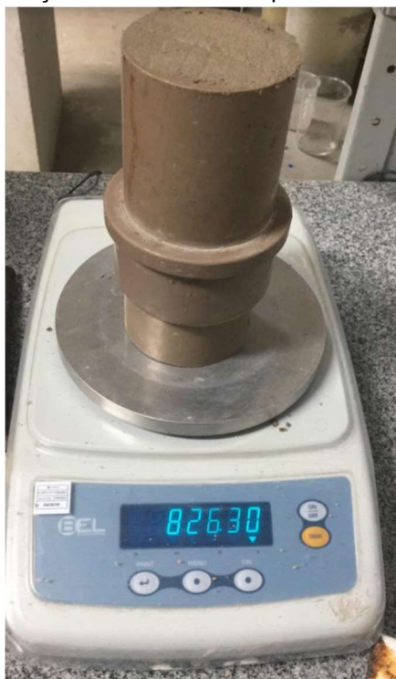
Figura 16 - Aferição da massa do recipiente com a argamassa.
