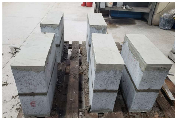
Figura 22 - (a) Confeção dos prismas com auxílio de nível de bolha, martelo de borracha, régua e esquadro. (b) Prismas confeccionados.
