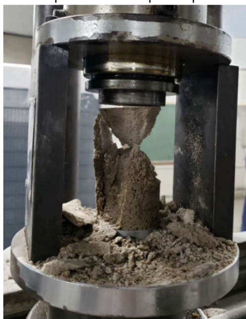
Figura 33 - Formas de rompimento dos corpos de prova de argamassa.
