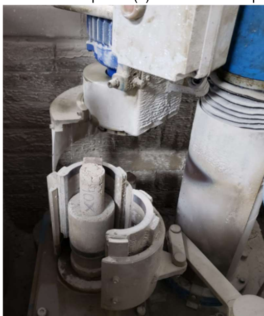
Figura 19 - (a) Posicionamento na máquina retífica para capeamento das extremidades dos corpos de prova. (b) Resultado do capeamento com máquina retífica.
