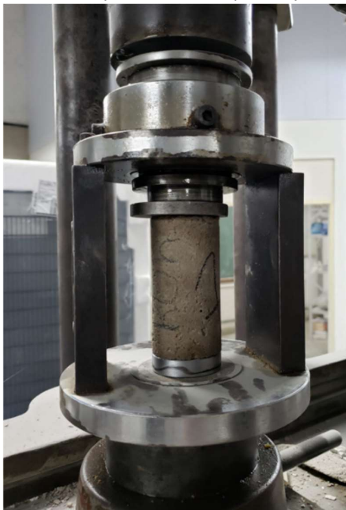
Figura 20 - Ensaio de compressão dos corpos de prova de argamassa.
