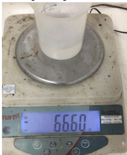
Figura 10 - Pesagem da água adicionada às misturas.
