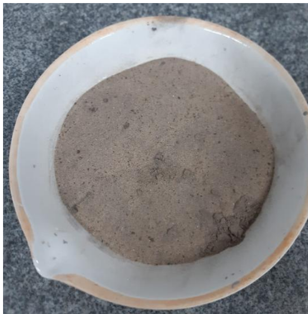
Figura 4 - Areia de rejeito de mineração utilizada na pesquisa.
