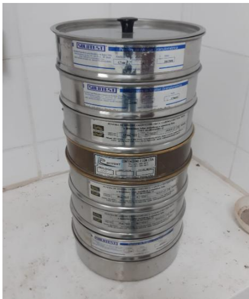
Figura 6 – Série de peneiras utilizada no ensaio de granulometria.
