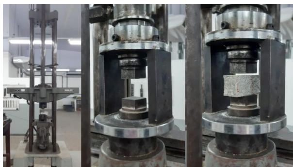
Figura 27 - Corpo de prova sendo ensaiado à compressão.
