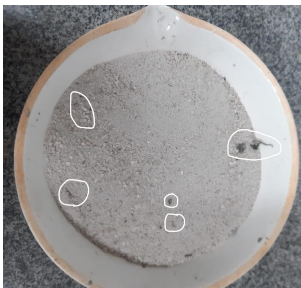
Figura 14 - Amostra de Areia Natural com substâncias nocivas.
