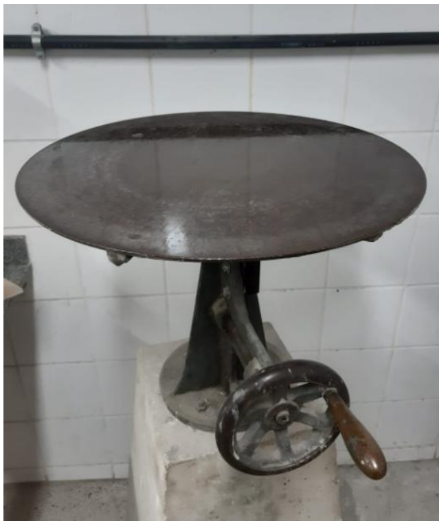
Figura 24 - Mesa para realização do ensaio de índice de consistência.
