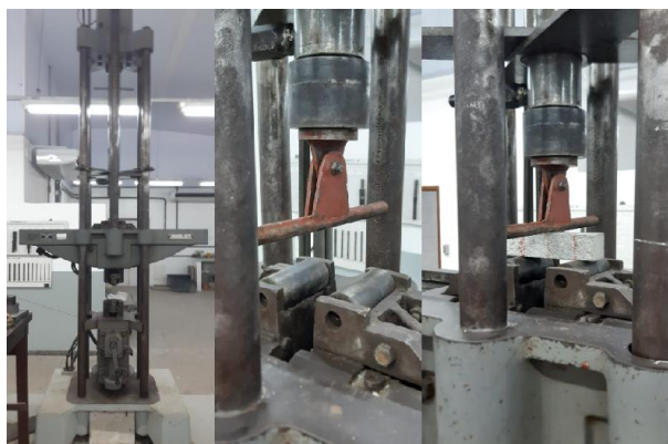
Figura 26 - Corpo de prova sendo ensaiado à tração na flexão.
