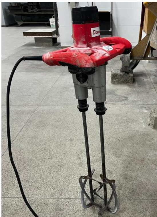
Figura 22 - Misturador vertical utilizado para confecção das argamassas.
